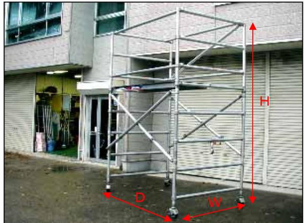
1段の設置寸法：1490(W)×2110(D)×3280(H)
